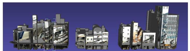
図4 MMS点群に基づくテクスチャ付3D都市モデル生成結果
