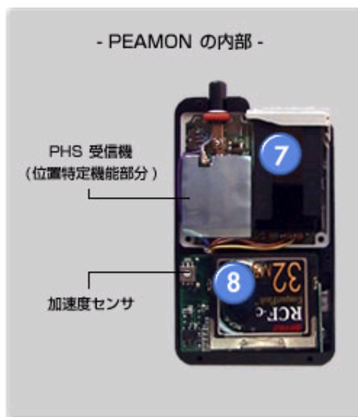
図 E.2: PEAMON の内部 ( http://www.e-tsu.org/index2a-1c.html より)
