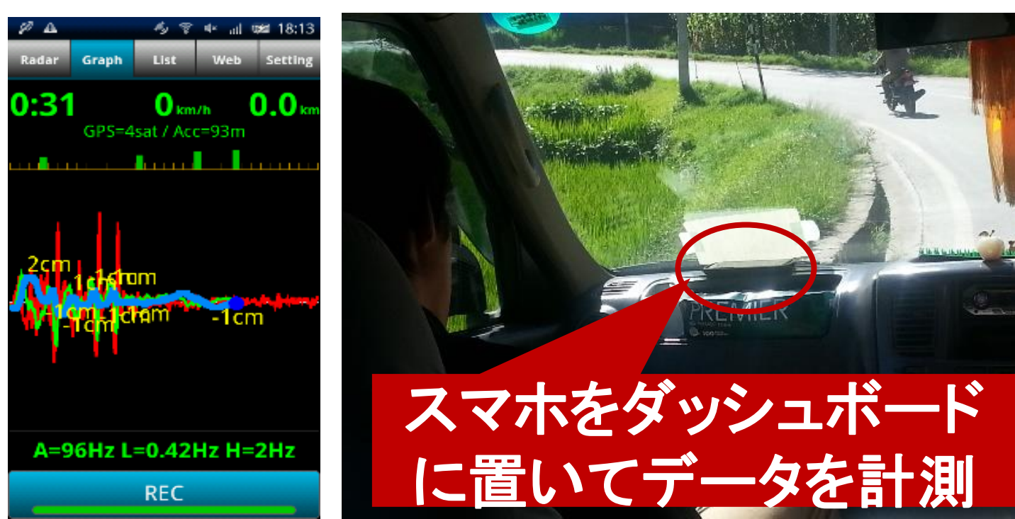
Bump Recorderのスマホ画面と計測状況
